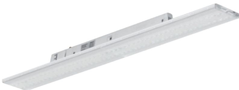
3-Phasen-Stromschienenleuchte | Aluminium weiß, Abdeckung opal, mit 3-Phasen-Stromschienenadapter, Abstrahlwinkel 90°, LEDs/230V, Lichtleistung kann über DIP-Schalter eingestellt werden, Lebensdauer 50.000 Stunden
