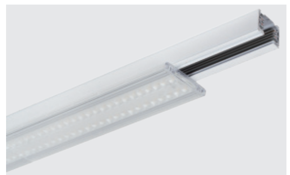
3-Phasen-Stromschienenleuchte | Aluminium weiß, Abdeckung opal, mit 3-Phasen-Stromschienenadapter, Abstrahlwinkel 90°, LEDs/230V, Lichtleistung kann über DIP-Schalter eingestellt werden, Lebensdauer 50.000 Stunden
