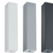
Pendel-Kabelkürzer | Kunststoff, ermöglicht das Kürzen der Kabel von Pendelleuchten, indem das Kabel einfach in dem Kabelkürzer aufgewickelt wird. Je nach Material und Dicke des Kabels ist eine Kürzung von ca. 80 cm möglich
